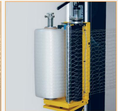
EM - Mechanische Bremse an der Spulwelle
